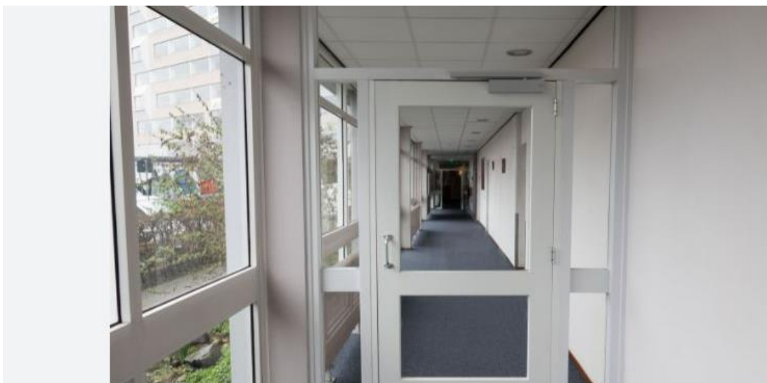
Figuur 2.6 Situatie die voldoet aan het Bbl: er staan geen spullen in de gang.
